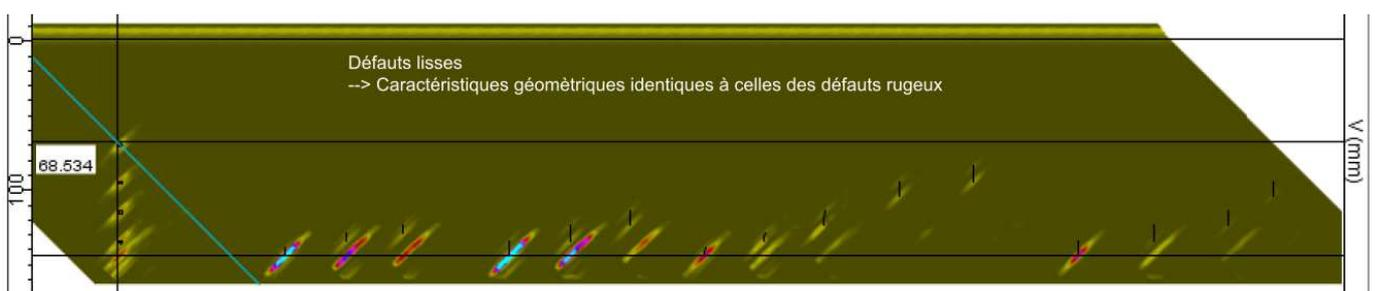
Figure 25 : Évaluation par simulation de la détection de défauts à faciès parfaitement lisse de dimensions 5 x 20 et 10 x 20, perpendiculaires à la peau externe ou légèrement désorientés
