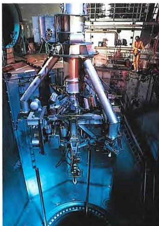
La machine d'inspection en service (MIS) pour le contrôle des cuves des REP
