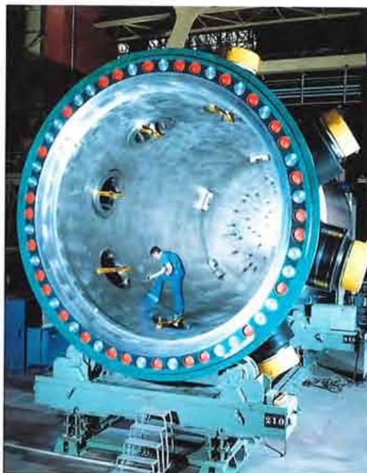
Cuve de réacteur à eau sous pression
