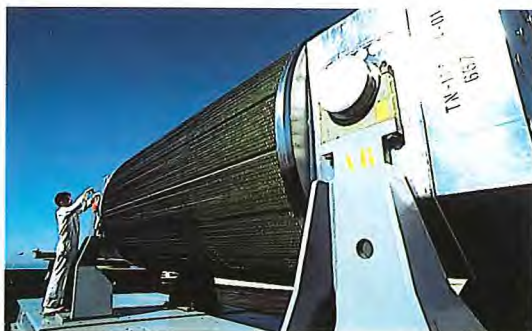
Château de transport de combustibles irradiés
