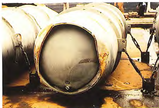
Conteneur d'hexafluore d'uranium endommagé à la suite de l'accident du navire Montlouis (1984)
