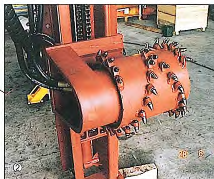
Outil utilisé pour l'écroûtage du béton irradiant dans les cellules de haute activité (1) vue d'ensemble, (2) l'outil et la glissière
