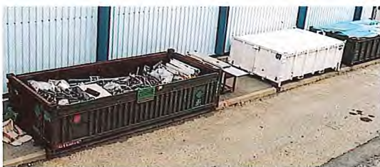
Bennes destinées à la collecte des déchets TFA, triés par nature (gravats, incinérables et divers)
