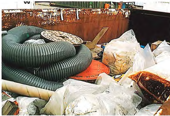
Intérieur d'une benne de type « OPEN-TOP », partiellement remplie avec des déchets TFA incinérables
