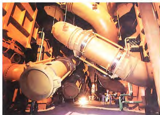
Groupe de diffusion gazeuse de l'usine George Besse d'Eurodif
