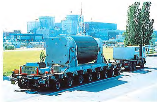
Transport par route d'un château contenant des combustibles irradiés
