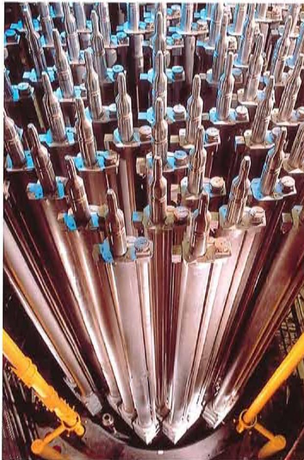
Chooz : mécanisme des barres de commande
