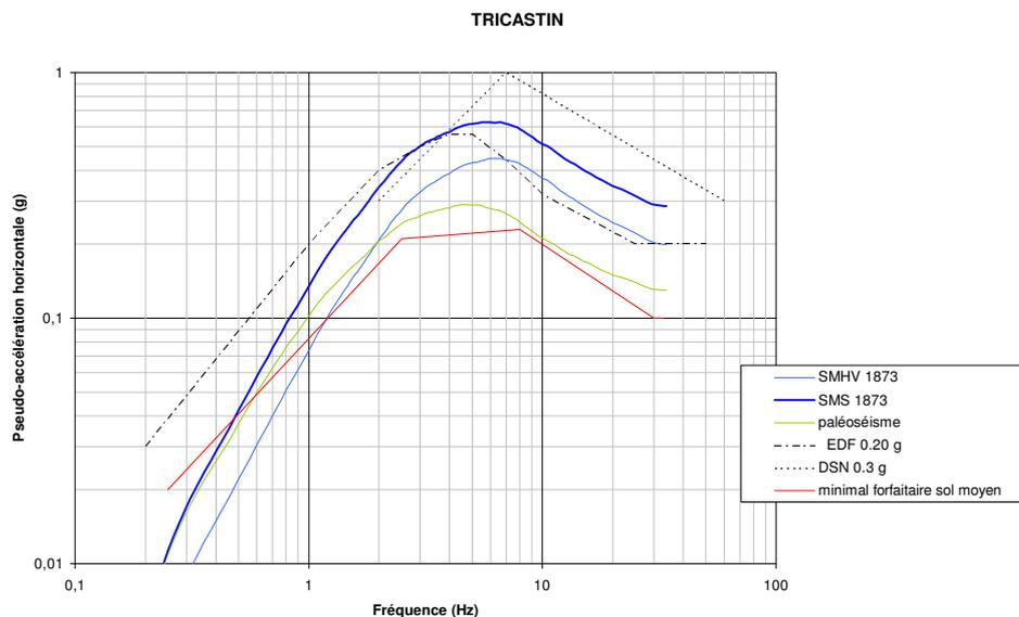
Le mouvement vertical associé au spectre de dimensionnement correspond aux deux tiers du mouvement horizontal.
