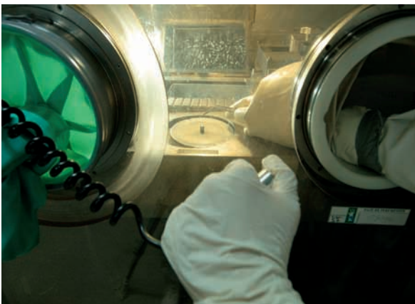
Contrôle des pastilles en boîte à gants – MELOX à Marcoule
