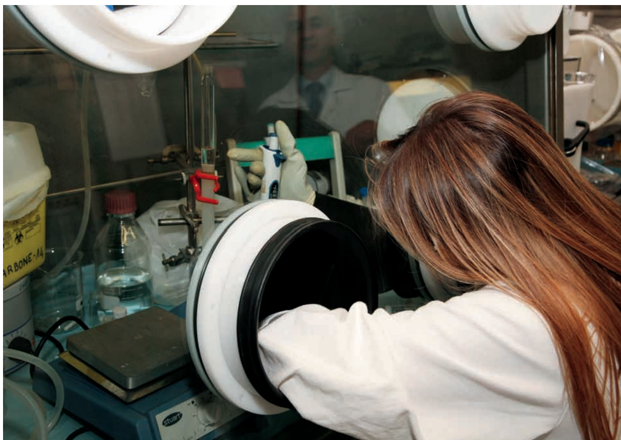
Utilisation de sources radioactives non scellées en recherche (opération de traçage)
