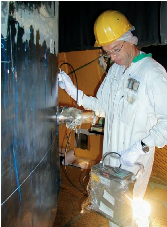
Contrôle par ultrasons d'un joint soudé
