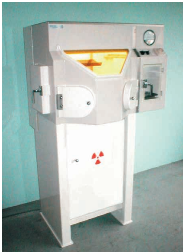
Enceinte blindée pour la manipulation de sources non scellées
