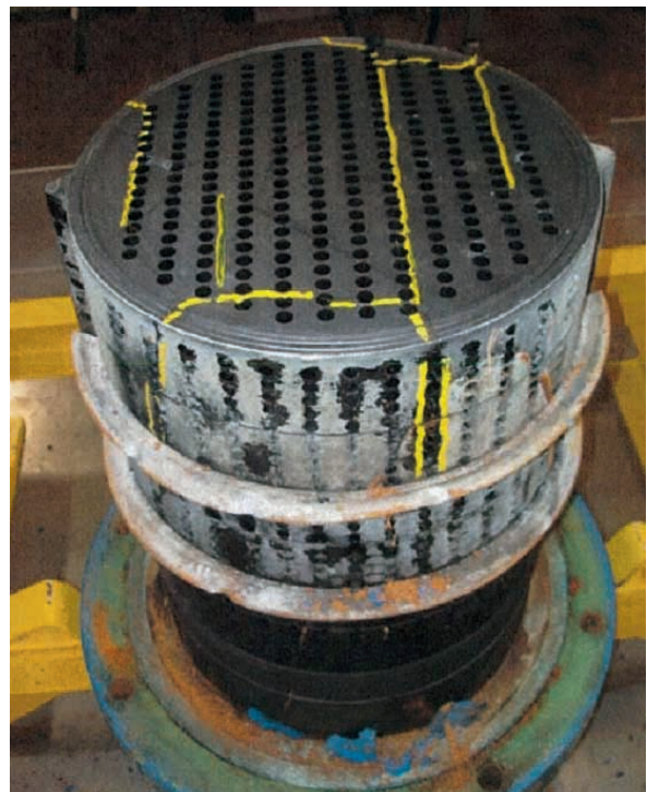
TU5 fissuration de l'échangeur
