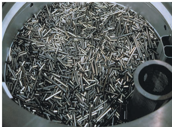
Coques issues des assemblages du combustible, atelier ACC de AREVA NC La Hague
