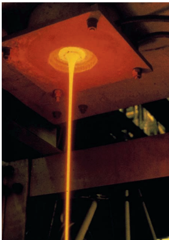
Vitrification d'une solution de produits de fission et d'activation
