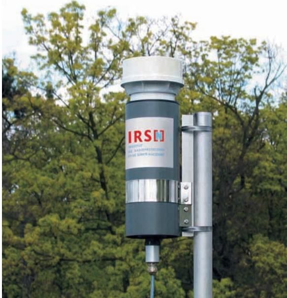
Balise TELERAY permettant la surveillance du débit de dose ambiant
