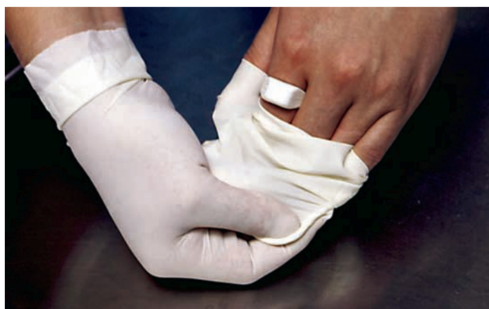
Bague thermoluminescente pour la radioprotection du personnel (mesure de la dose aux extrémités)
