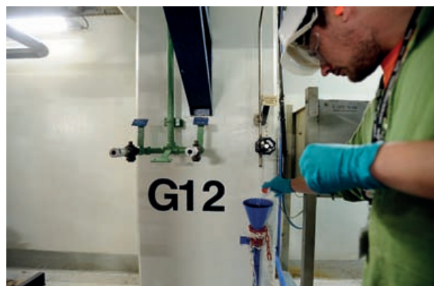
Prélèvement d'échantillons d'effluents radioactifs et chimiques lors d'une inspection de l'ASN sur le thème des rejets à la centrale nucléaire du Bugey – Mai 2012
