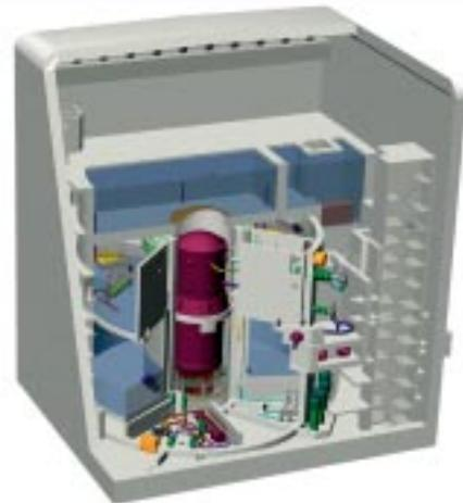
Figure 1 - Planche montrant une vue éclatée du SWR 1000
