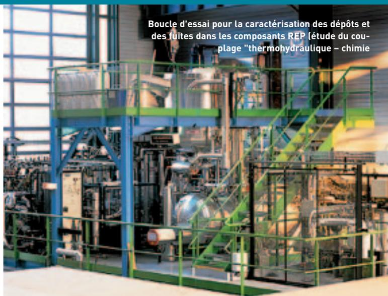
Boucle d'essai pour la caractérisation des dépôts et des fuites dans les composants REP (étude du couplage thermohydraulique - chimie)
