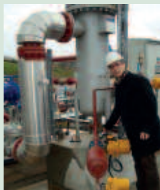
Florent Matouk mesure avec un AD6 de Saphymo les débits de dose liés aux dépôts naturellement radioactifs d'un site géothermique de Soultz – Décembre 2008
