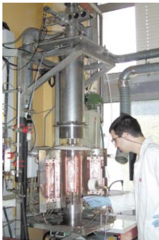
Appareil TEWARSON-CRIT nécessaire à l'acquisition des données de base de la combustion d'un produit ou d'un matériau
