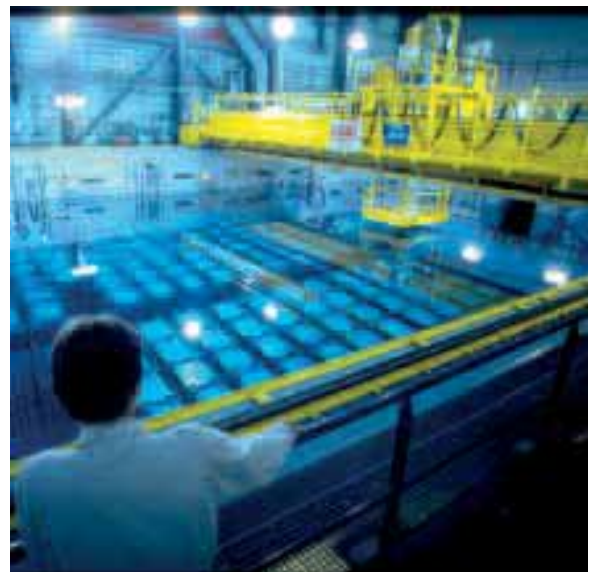
Vue de la piscine E, destinée à l'entreposage des combustibles usés dans l'usine AREVA NC à La Hague (Manche)
