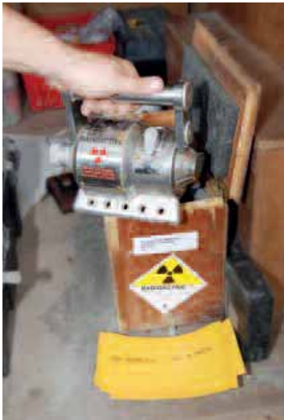
Appareil de gammagraphe et sa valise de transport
