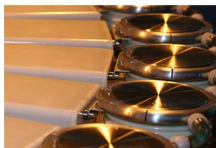
Générateur Linear Transformer Driver (LTD)
