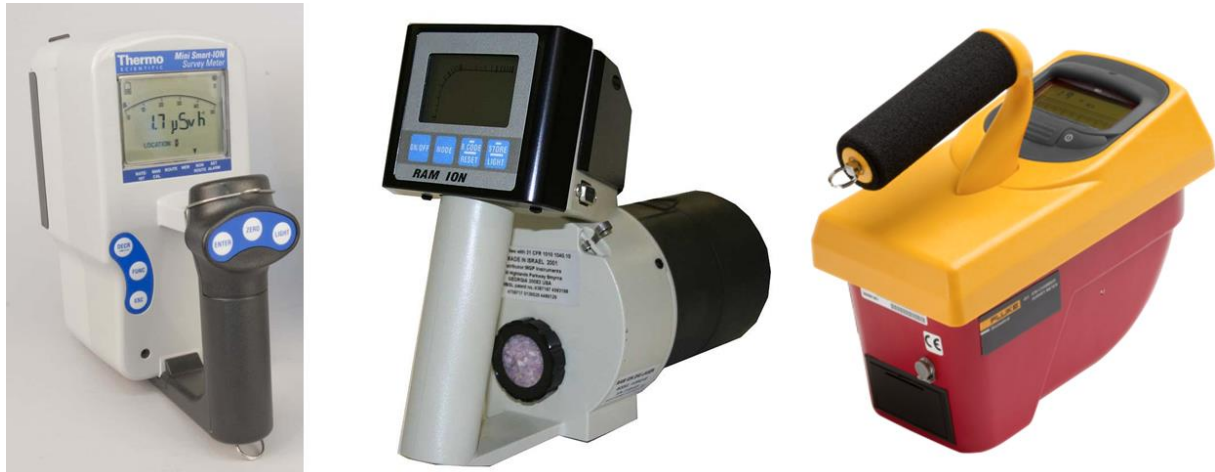
Figure 38 différents radiomètres de type chambre d'ionisation. De gauche à droite : mini smart ION (Thermo Scientific), RAMION (ROTEM), 451P (Fluke Biomedical)
