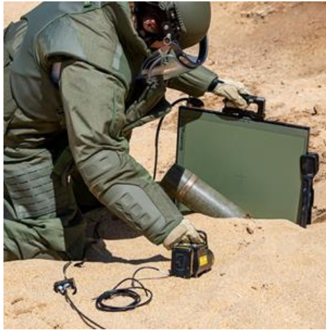
Figure 21 - Préparation d'un tir radiographique sur une munition (crédit photo scopex.fr)
