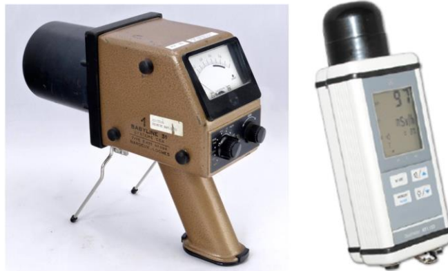
Figure 36 - BABYLINE (à gauche) et AT1123 (à droite) deux appareils souvent cités pour la mesure de champs pulsés
