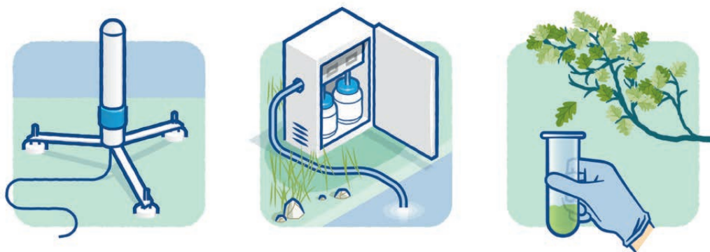
Figure 11. Différents moyens de la surveillance radiologique de l'environnement. À gauche, une balise Teleray ; au centre, un appareil de prélèvement de l'eau de rivière ; à droite, un prélèvement de feuilles.
