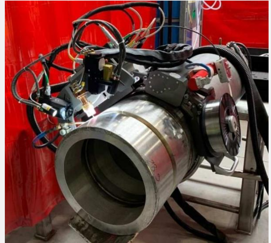
Photo EDF - Phase automatisée d'une opération de soudage
