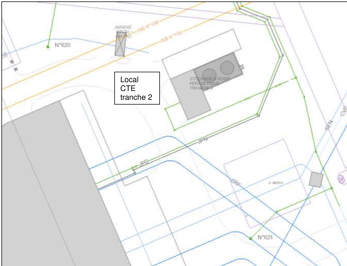
Figure 15 : Réseau incendie à proximité de l'installation CTE (tranche 2)
