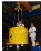
PNS ( ^{252}\text{Cf} , 28 GBq) pour le démarrage des EPR
