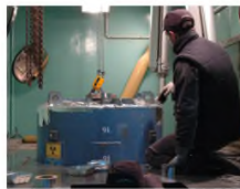
Source de ^{60}\text{Co} (plusieurs centaines de TBq) pour irradiateur gamma
