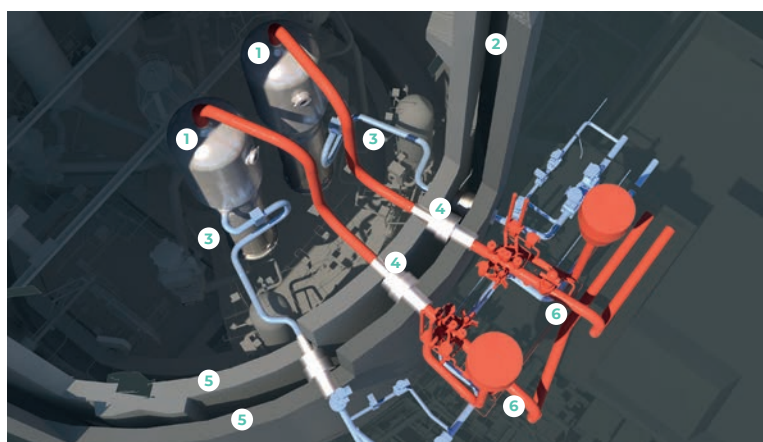
1 Générateurs de vapeur 2 Espace annulaire 3 Circuit de régulation du débit d'eau alimentaire 4 Traversées 5 Double enceinte de confinement 6 Systèmes d'évacuation de la vapeur (VVP)
