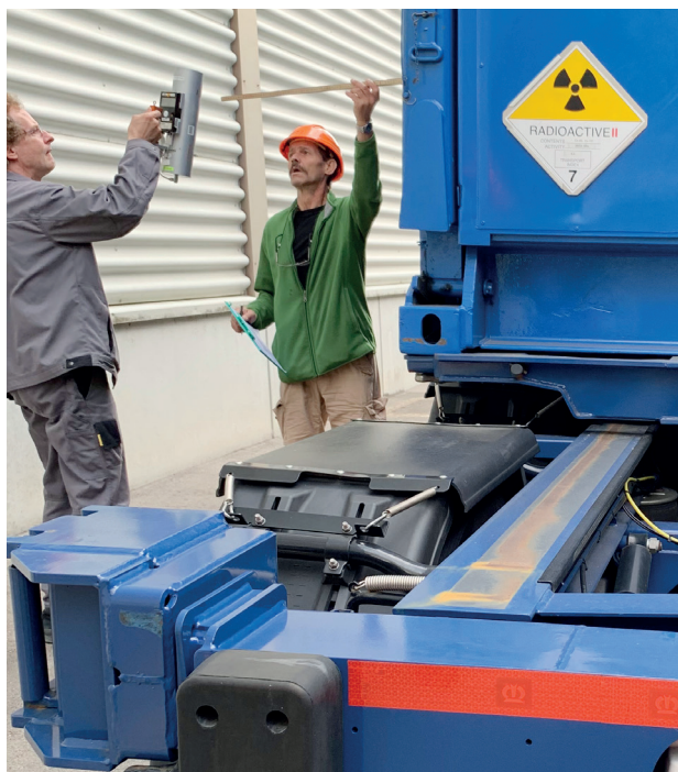
Mesures radiologiques d'un colis industriel avant son expédition
