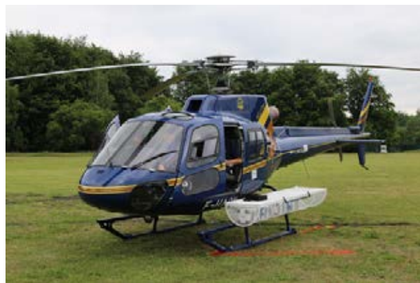
Hélicoptère embarquant dans les paniers extérieurs latéraux les détecteurs du système mobile de mesure par spectrométrie gamma ULYSSE développé par l'IRSN
