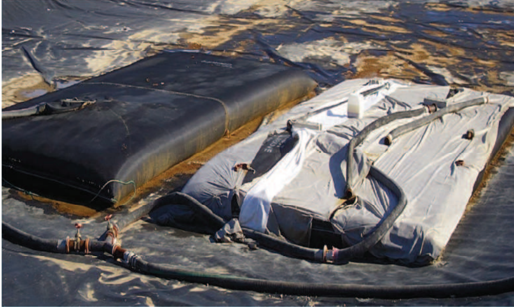
Figure 19 : Photo réalisée pendant la phase de test industriel de filtration en géotube (à gauche un géotube recouvert du géotextile)
