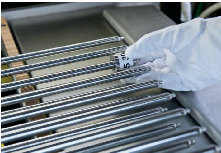
Contrôle visuel des crayons, usine Mélox de fabrication de combustible MOX, Bagnols-sur-Cèze.
