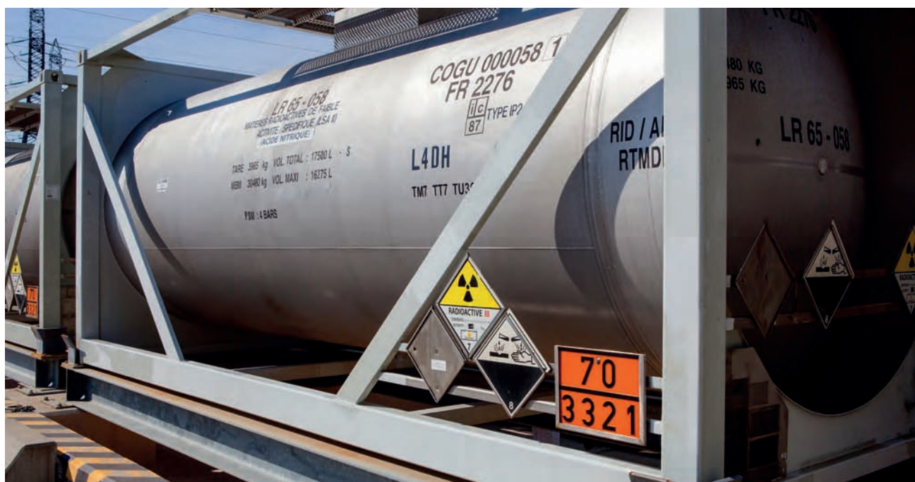
Citerne contenant du nitrate d'uranyle.
