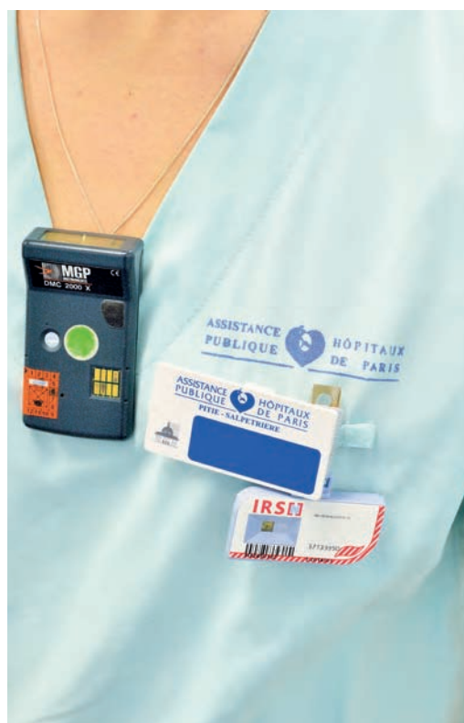
Port de dosimètre opérationnel et dosimètre passif par un personnel hospitalier.
