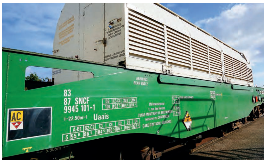
Wagon servant au transport de colis de déchets vitrifiés.
