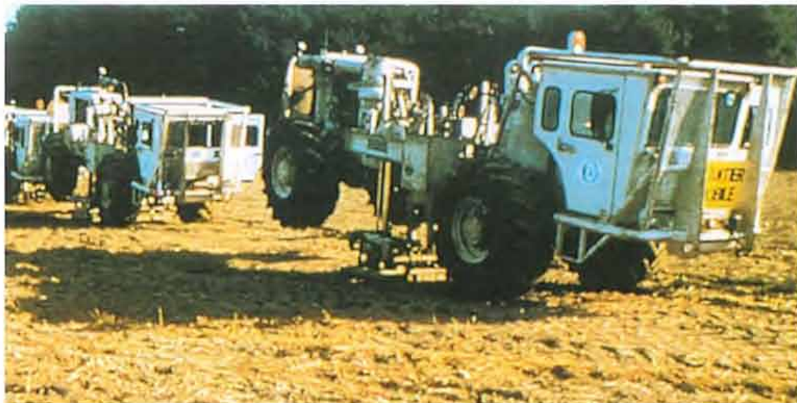
Camions vibrateurs lors d'une campagne de reconnaissance géologique
