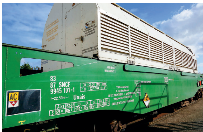
Wagon servant au transport des colis de déchets vitrifiés.
