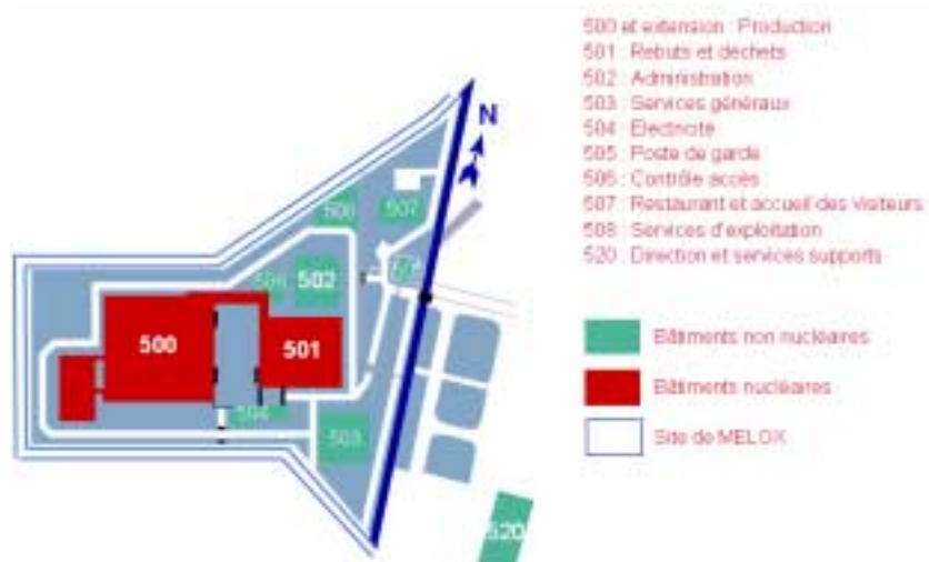
Figure 12 : Implantation des bâtiments
