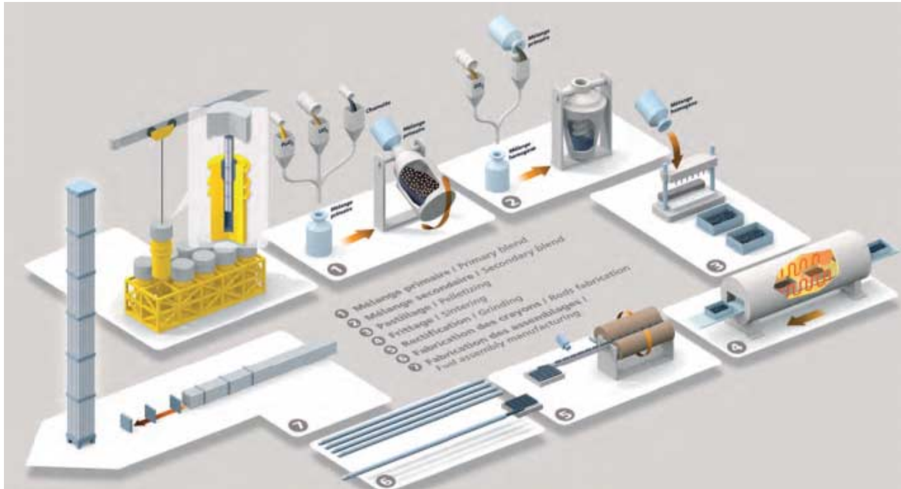
Figure 13 : procédé de fabrication du combustible MOX
