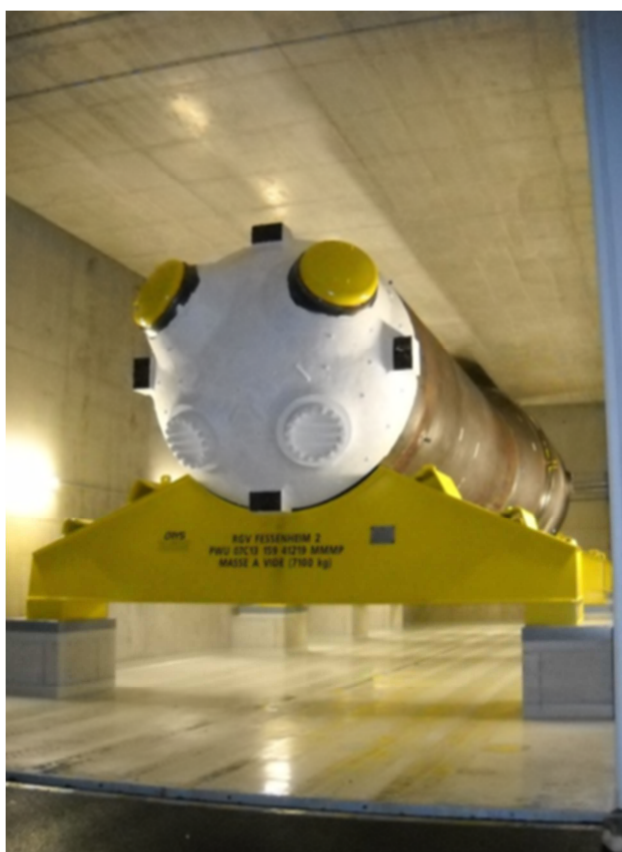
Figure 11 - Générateur de vapeur
